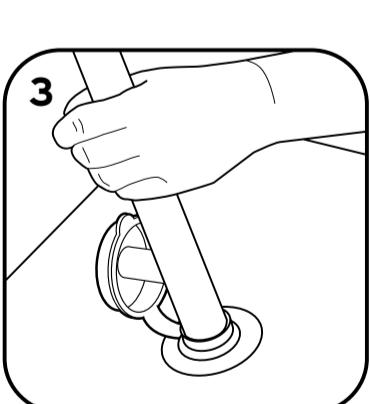
Verschlusskappe entfernen. Staubsaugerrohr aufsetzen und Luft aus dem Beutel saugen. Drücken des Beutels erleichtert das Absaugen.
